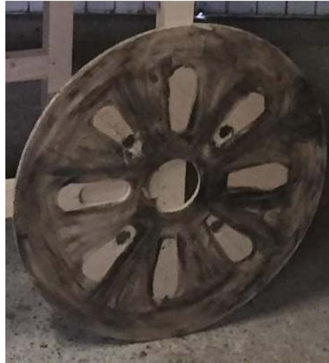
Une fois le motif décidé, il reste à découper l'intérieur des roues. Pour cela, on a utilisé une perceuse avec une mèche de 12 pour effectuer des avant-trous. Ensuite, place à la scie sauteuse pour faire les 16 trous des 2 roues.
