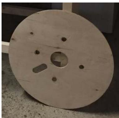
Pour effectuer le motif intérieur des roues, nous avons dessiné les emplacements des trous et remplis en noir (on a utilisé un bouchon de vin brûlé pour colorier en noir) afin de se rendre compte du motif final.
